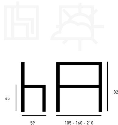
Banca de 2, 3 y 4 plazas 2 con mesa y 3 con mesa, con asiento y respaldo multiperforado en polipropileno, con base de 4 patas en tubular de acero pintado o cromado y travesaño en PTR pintado.
